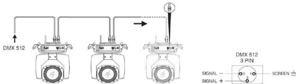
Conecte el XLR macho de su primer cable de señal a la salida DMX512 del controlador y del otro lado conecte el XLR hembra al primer equipo en el conector macho de la base. Puedes conectar varios equipos en la misma cadena. Por favor vea el siguiente diagrama.
