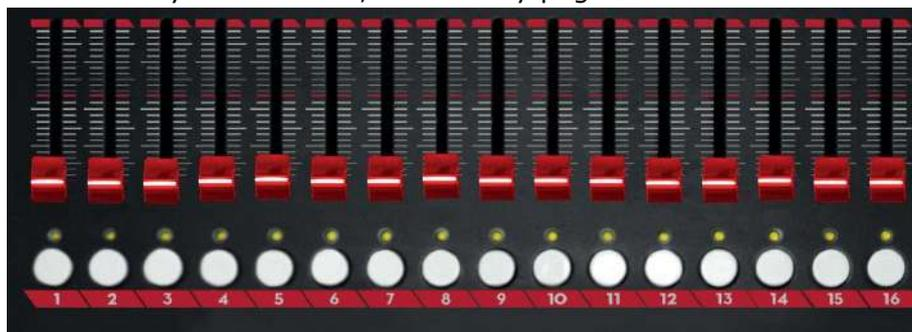
Hay 6 páginas de luminarias para un total de 96 luminarias. El botón <Attribute/Level> puede ser usado para cambiar las funciones de los 16 faders. Cuando se activa <Attribute>, los controles deslizables se utilizan para ajustar el valor del atributo que está por encima de los controles deslizables; Cuando <Level> se activa, los controles deslizables son para ajustar la intensidad de dimmer de las luminarias.
