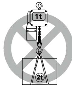
La carga no puede rebasar el límite de la capacidad de carga soportado por el polipasto
