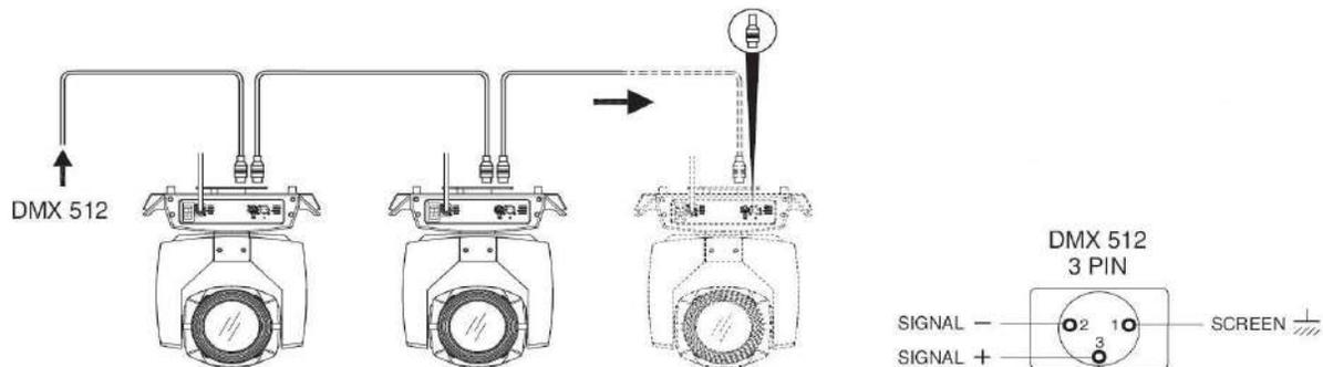
Conecte el XLR macho de su primer cable de señal a la salida DMX512 del controlador y del otro lado conecte el XLR hembra al primer equipo en el conector macho de la base. Puedes conectar varios equipos en la misma cadena.
