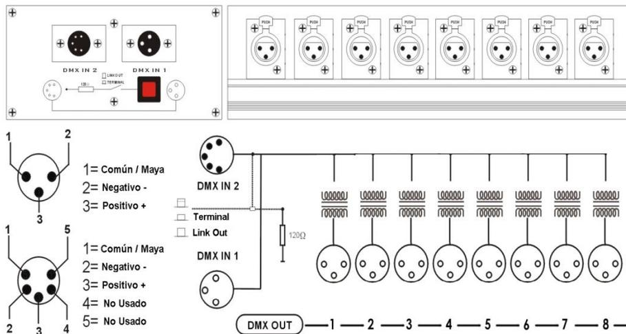
La amplificación permite extender la longitud de la línea más allá de la distancia especificada en la norma estándar DMX-512.
